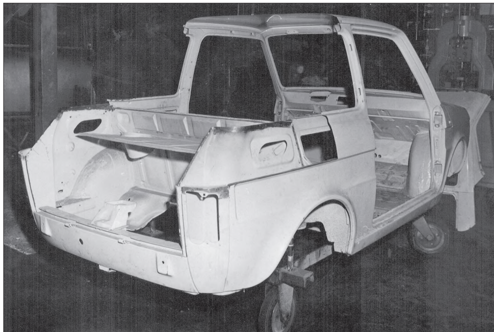
„Spreparowane” nadwozie Fiata 126p na bazie którego wykonaliśmy Bombla
